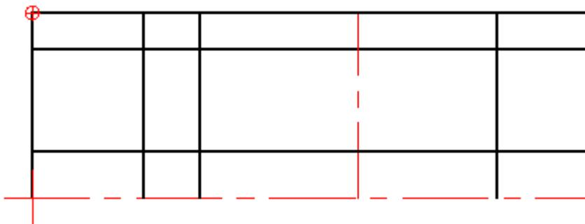
Zeichnen Sie jetzt alle notwendigen Linien mit der Parallel-Funktion, bis es wie oben dargestellt aussieht. Alle sichtbaren Kanten sowie die Achse der Gewindebohrung sind gezeichnet.
